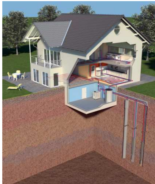
Erdwärmesonde: Kunststoffrohr in Bohrung mit Verpressmaterial
