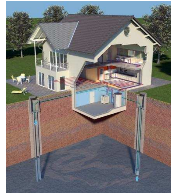
Grundwasser- Wärmepumpe: Förder- und Schluckbrunnen
