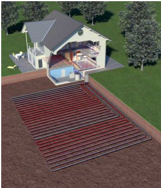
Erdwärmekollektor: Rohrregisterfeld in 1,5 m Tiefe
