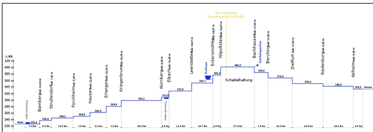
Abbildung 69: Höhen- und Längenprofil des Main-Donau-Kanals ([wikipedia.org/wiki/Main-Donau-Kanal](https://de.wikipedia.org/wiki/Main-Donau-Kanal)).
